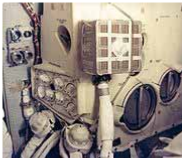
Le « bricolage de fortune » que l'équipage dut réaliser pour adapter les filtres à CO 2 d'Odyssée dans le LEM
