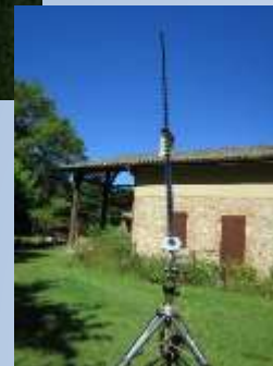
Yagi disk 5 éléments 1420 MHz
