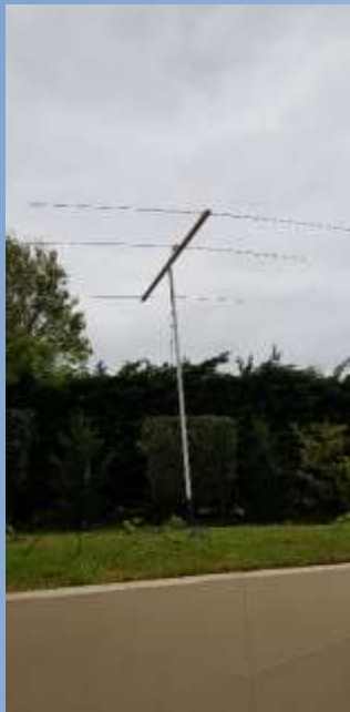
Yagi 3 éléments 50 MHz
