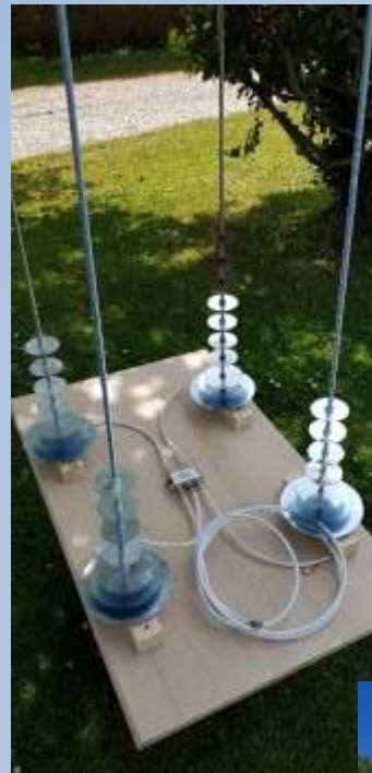
Yagi disk 5 éléments 1420 MHz
