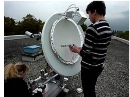
Figure 13 : Alignement avec le Nord magnétique
