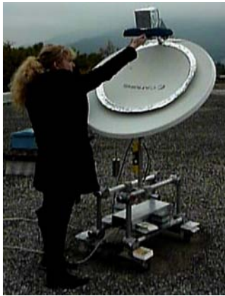
Figure 14 : Mesure avec un corps noir à 300K
