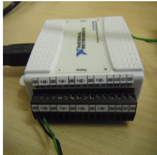
Figure 11: CAN NI USB permettant de numériser le signal analogique provenant du ciel, de commander le switch depuis le PC.
