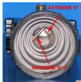
Figure 6 : cornet corrugué ou graduel et les 2 antennes
