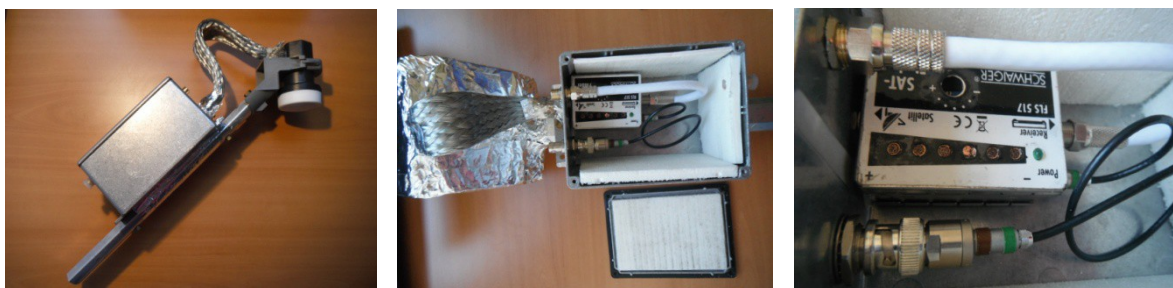
Figure 9 : (gauche): LNB + convertisseur RF/DC reliés par câble RF ; (centre) : satfinder avec câble blanc RF pour alimentation 13V ou 18V ; (droite) : zoom sur câble noir LEMO qui transporte la tension analogique V_{ciel} (le signal qui nous intéresse !)
