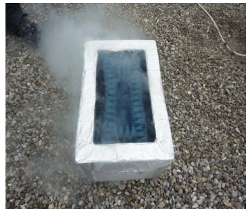
Figure 15 : (à gauche) Mesure avec un corps noir à 77K (azote liquide) (à droite) Corps noir à 77K
