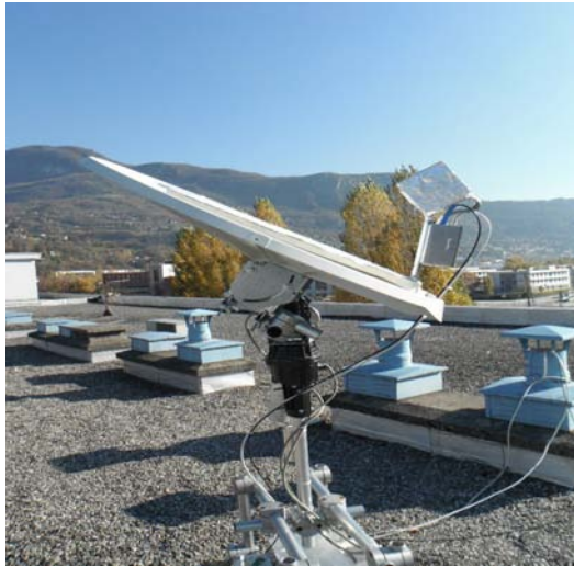
Figure 12 : (gauche) : expérience P&W sur le toit du LPS C ; (haut-droite) : ensemble de l'électronique pour l'acquisition de V_{ciel} ; (bas-droite) : le connecteur BNC/Lemo de V_{ciel} avec la source de référence (la petite puce noire) V_{ref} entrant chacun dans l'ampli d'instrumentation pour la mesure différentielle. Les câbles vert et noir vont ensuite aux entrées analogiques du CAN. Les câbles rouge-bleu-vert sont les câbles d'alimentation en \pm 15V .
